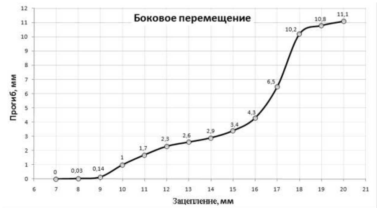
Рисунок 10 - График зависимости бокового прогиба проводника в состоянии соскальзывания от первоначального зацепления при силе из графика рис. 8 для каждой величины перекрытия
