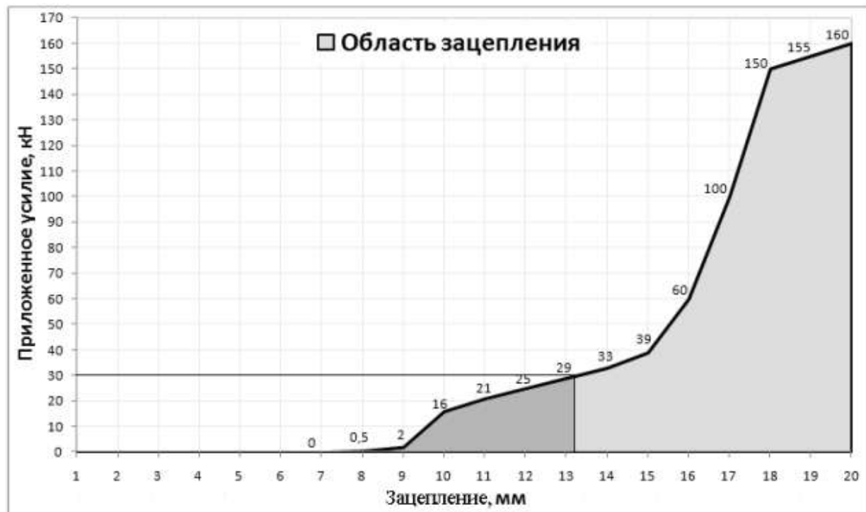
Рисунок 8 - График, определяющий зависимость между боковой нагрузкой и минимально допустимым зацеплением башмаком проводника по критерию выхода из зацепления
